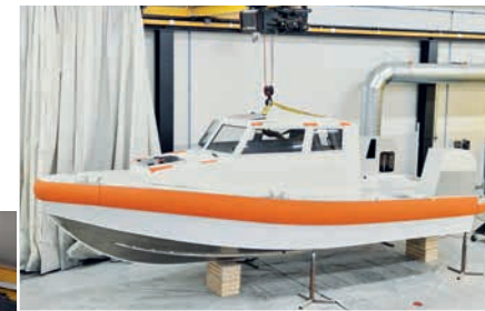
Das erste Seenotrettungsboot der neuen 8,4-Meter-Klasse nimmt Form an. Drei Einheiten für die Stationen Wustrow, Zingst und Zinnowitz sind vorgesehen. Die Aluminiumboote mit Jetantrieb werden wie ihre 1993 gebauten 7-Meter-Vorgänger auf Spezialtrailern über den Strand zu Wasser gebracht – entweder zur offenen Ostsee oder zu den weit verzweigten rückwärtigen Bodden und Haffs.
