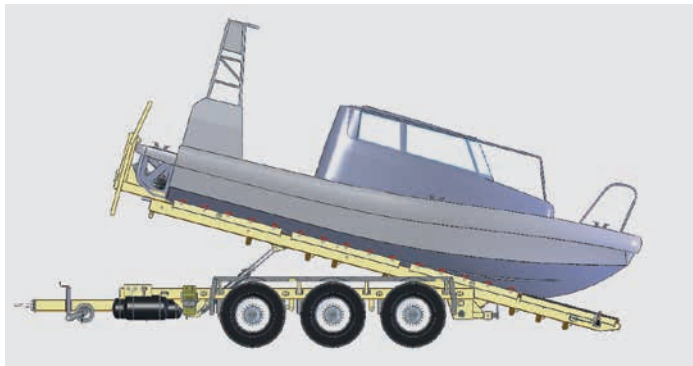
Entwurfszeichnung für die dreiachsigen Spezialtrailer der neuen 8,4-Meter-Seenotrettungsboote
