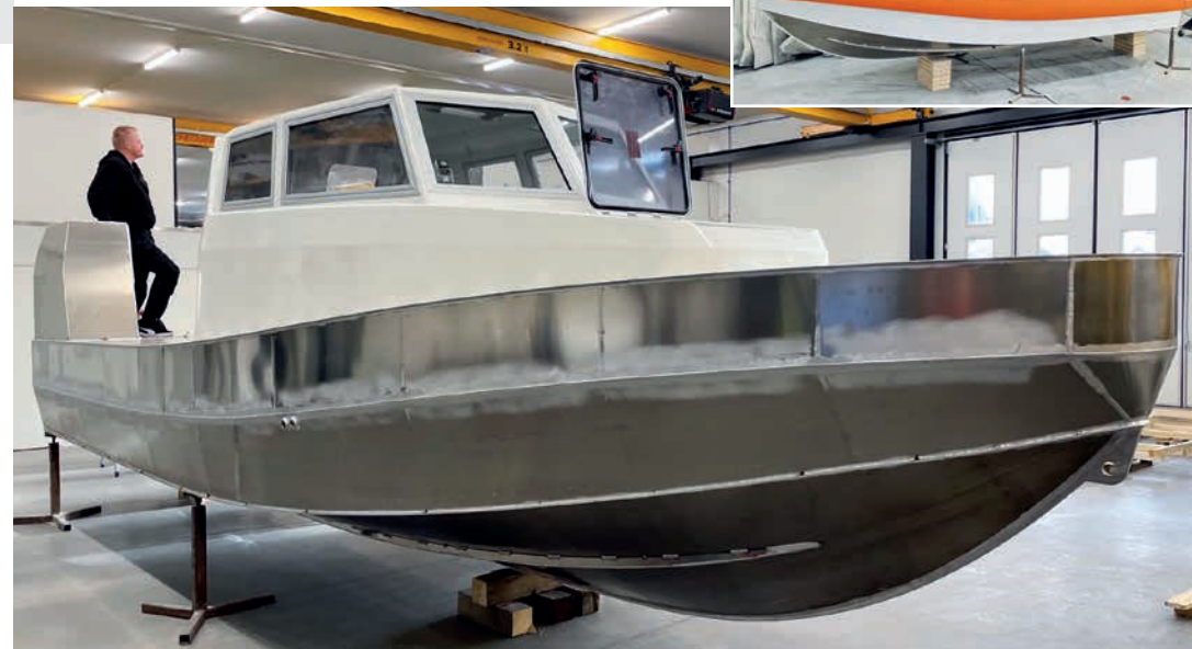
Das erste Seenotrettungsboot der neuen 8,4-Meter-Klasse nimmt Form an. Drei Einheiten für die Stationen Wustrow, Zingst und Zinnowitz sind vorgesehen. Die Aluminiumboote mit Jetantrieb werden wie ihre 1993 gebauten 7-Meter-Vorgänger auf Spezialtrailern über den Strand zu Wasser gebracht – entweder zur offenen Ostsee oder zu den weit verzweigten rückwärtigen Bodden und Haffs.
