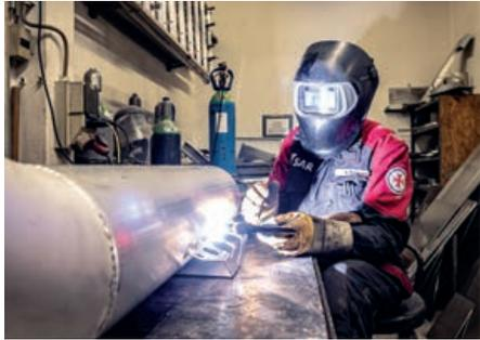
Maschinenschlosser Armin Rohde (56) schweißte die Ladeluftrohre der Hauptmaschinen zusammen. Bis 2001 baute er auf der Schweers-Werft unter anderem neue DGzRS-Einheiten.
