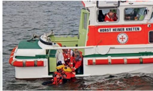
Erste Generation: 1971/1972 entstanden zwölf 7-Meter- und zwei 12-Meter-Boote. Besondere Ausstattung der kleinen Einheiten war schon damals die Bergungspforte, eine Tür in der Bordwand, um Schiffbrüchige schonend waagrecht zu retten (im Bild rechts bei der modernen HORST HEINER KNETEN).
