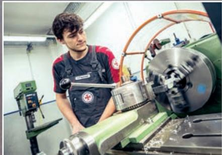
Feinwerkmechaniker Tim Pawlowski fertigt an der Drehmaschine spezielle Bauteile an.
