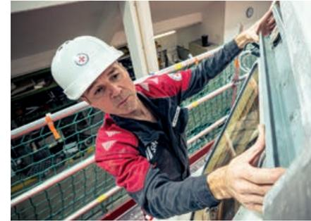
Maschinenschlosser Stefan Neundorfer nimmt an der Brücke Maß für die Befestigungen der neuen Hochleistungsscheibenwischer, die er später anbauen wird.
