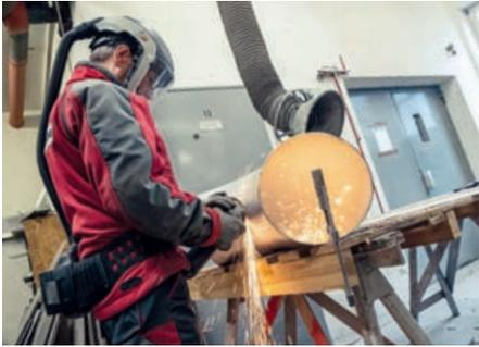
Schiffbauer Detlef Bandorski (60) sägt mit einem Winkelschleifer neue Abgasrohre aus Edelstahl zurecht. Sein großes handwerkliches Können setzt er seit 1992 für die Seenotretter ein.
